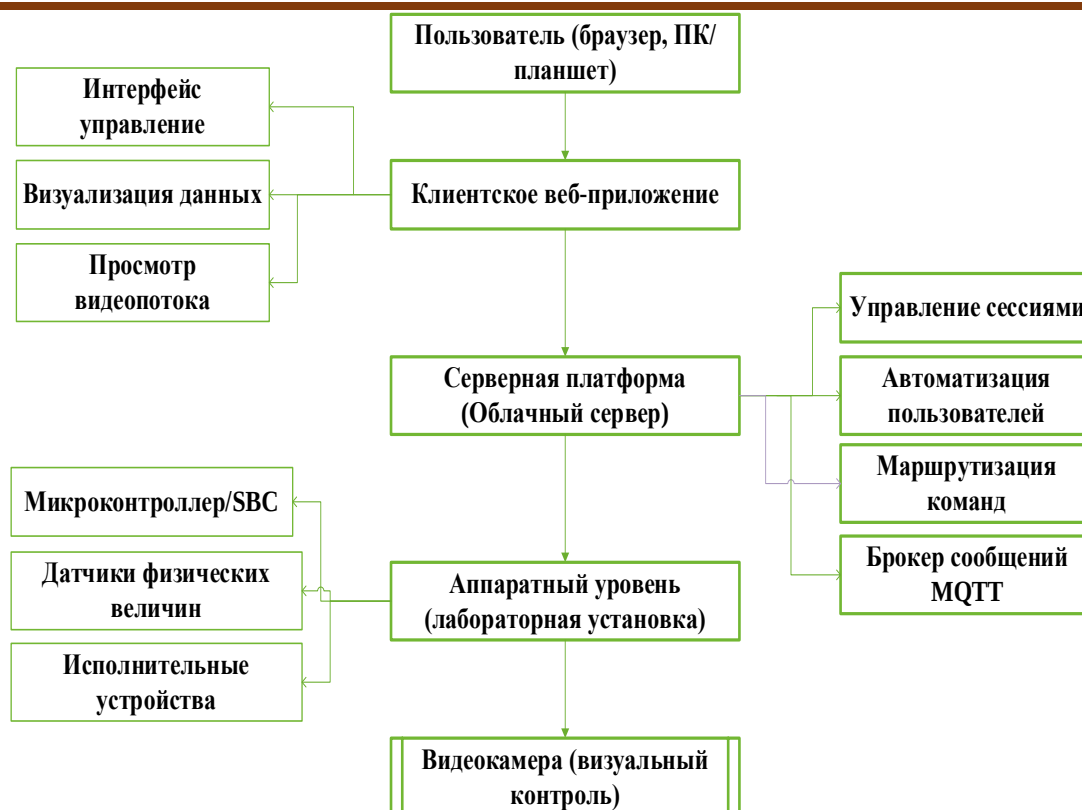
Рисунок 1 – Архитектура облачной платформы удалённого физического эксперимента
